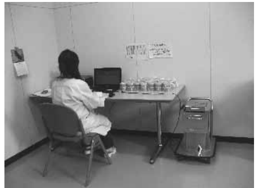
図1 NaI シンチによる牧草の簡易放射線検査
