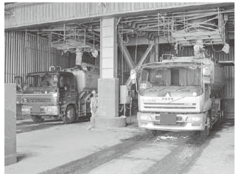
飼料製造工場タンクからの製品積み込み
